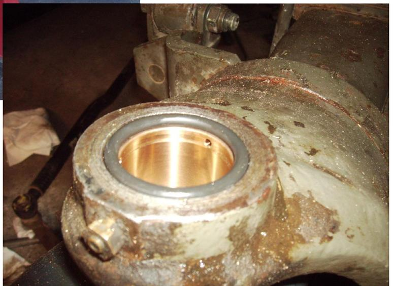
**Bild 25: Gut zu sehen der Neue Dichtungsring (Grau) eine der 3 Bohrungen und ganz wichtig das Druckentlastungsventil des Lagers durch das Überschüssiges Fett austreten kann. Dieses Ventil reinigen da damit die Funktion der Schmierung wieder hergestellt wird**
