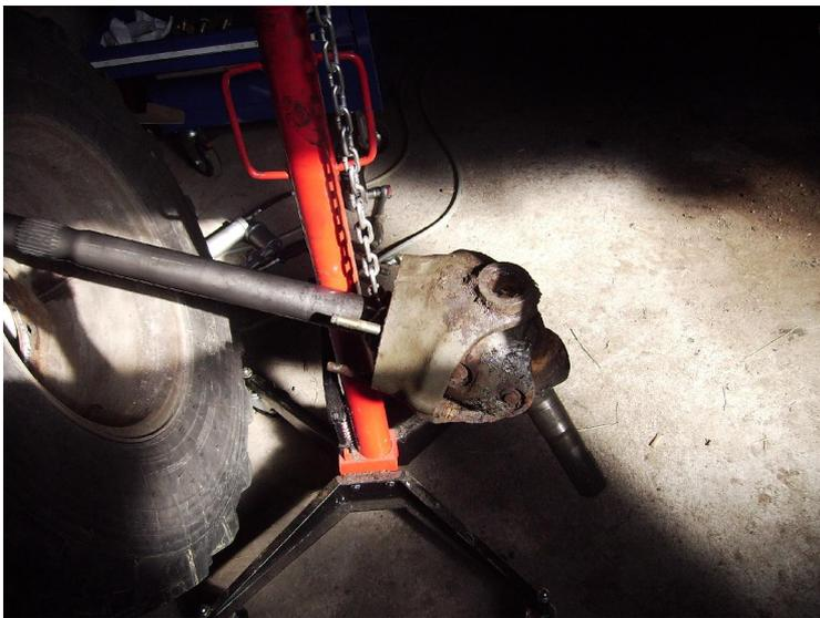
Bild 17: Da hängt sie die Steckachse samt Achsgabel
