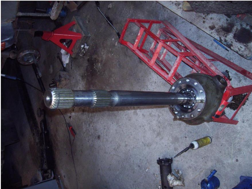
**Bild 19: Neue Steckachse mit Achsgabel, Anlaufring und Sprengring**
