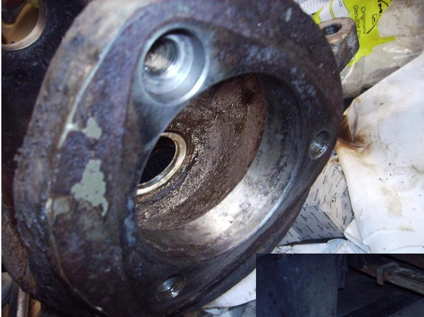
**Bild 27: Untere Lagerung des Achsschenkels mit Bohrung für die Passhülse**
