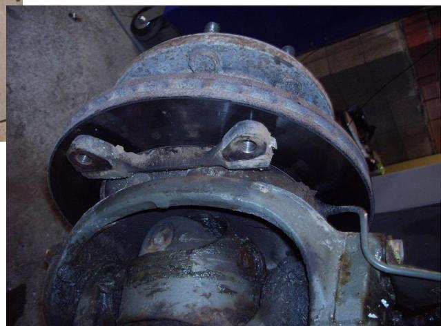
**Bild 10: Halterung des Bremssattels**
