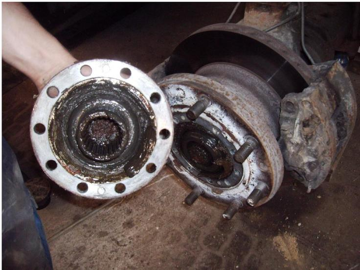
**Bild 7:** Mitnehmer abgebaut. Vorsichtig allseitig lockern da er (bei mir) zusätzlich mit Dichtmasse verklebt! war.
