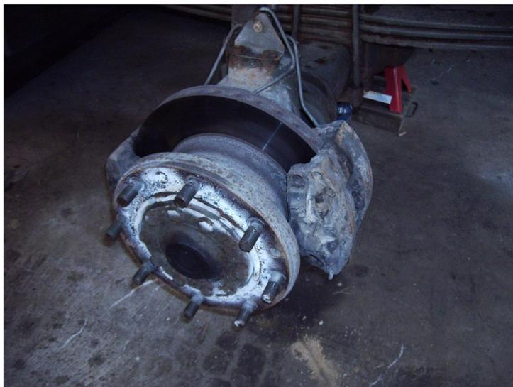
Bild 4: Rad demontiert
