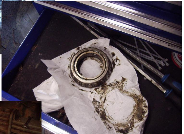
**Bild 13:** Äusseres Radlager entnommen und geschützt abgelegt
