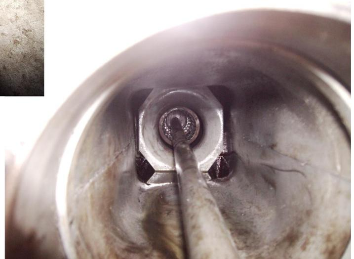
Bild 16: Blick ins Achsrohr mit wieder eingerasteter Sperre
