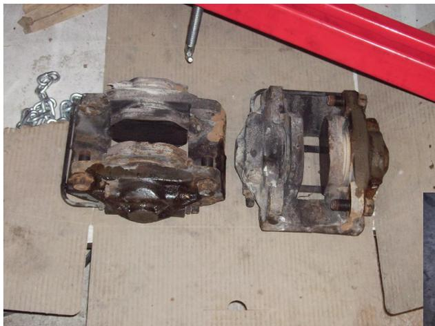
**Bild 11: Bremssattel abgelegt, die nassen Flecken sind ausgelaufene Bremsflüssigkeit**
