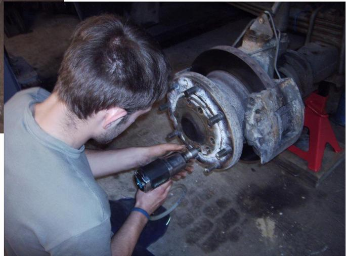
**Bild 6:** Zum reinen Schrauben ist ein Schlag/Akkuschrauber sehr empfehlenswert
