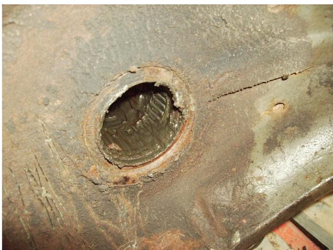
**Bild 21:** Diese Nadelhülse war völlig fertig und hat das Spiel der Steckachse verursacht. Der Schaden ist durch den kaputten Simmering entstanden durch den Feuchtigkeit und den Lausitzer Schlamm eindringen konnte. Weitere Schäden hab ich unbeabsichtigt durch exzessives Schmieren verhindert.
