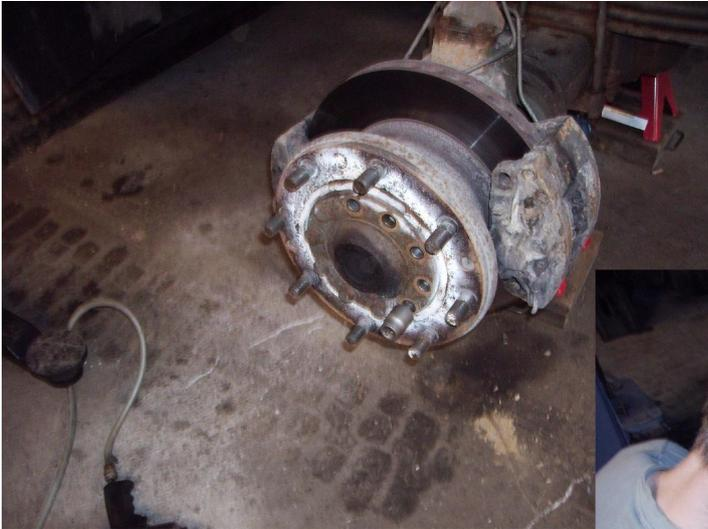
**Bild 5:** gelockerte und teilweise herausgeschraubte Mitnehmerschrauben
