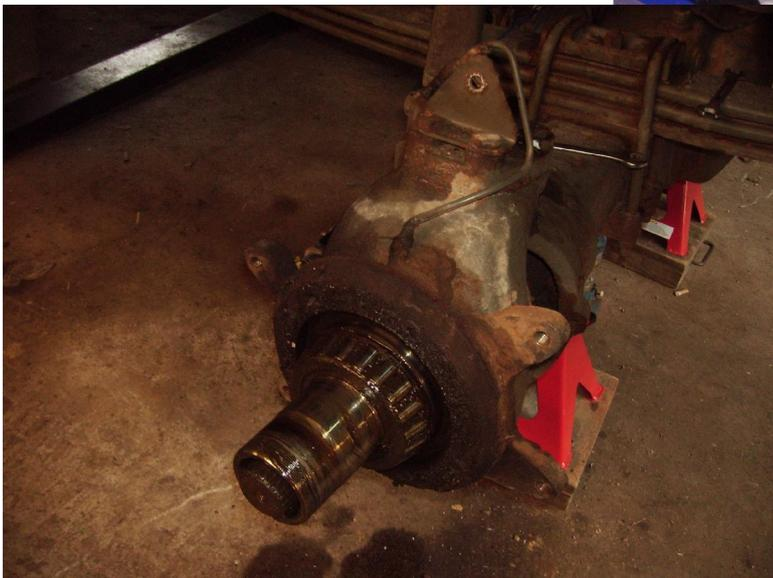
**Bild 14:** Radnabe mit innerem Radlager
