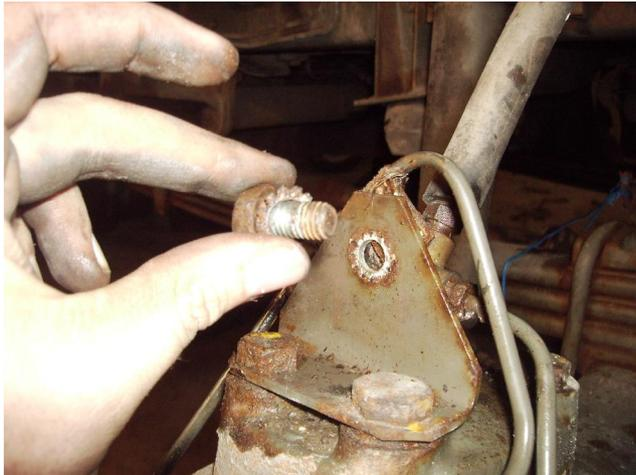
**Bild 8: Halterung der Bremsleitung abgeschraubt**
