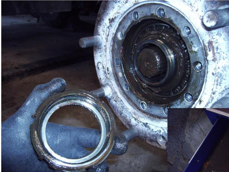
**Bild 12:** Nutmutter abgeschraubt, ab jetzt sind die Radlager frei zum entnehmen
