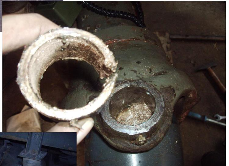
**Bild 24: Ausgefräste Lagerung**
