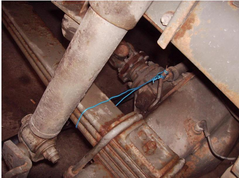
Bild 3: das reicht nicht als Sicherung der Diff-Sperre
