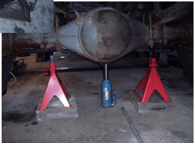
**Bild 2: Anheben der VA mit 10to Wagenheber und abstellen auf 2 Stk. 6to Böcken**
