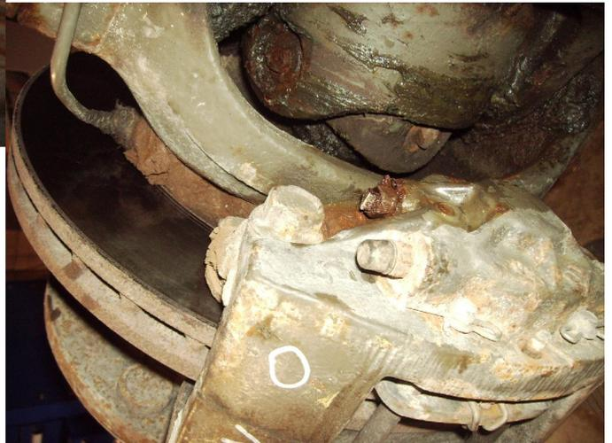
**Bild 9: Bremssattel markiert, bereit zum Abschrauben**
