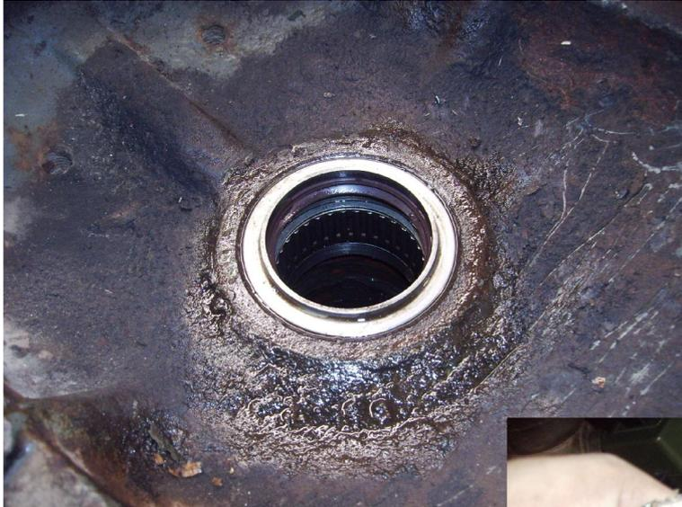
**Bild 23: Neues Nadellager mit neuem Simmering und Dichtungstopf**
