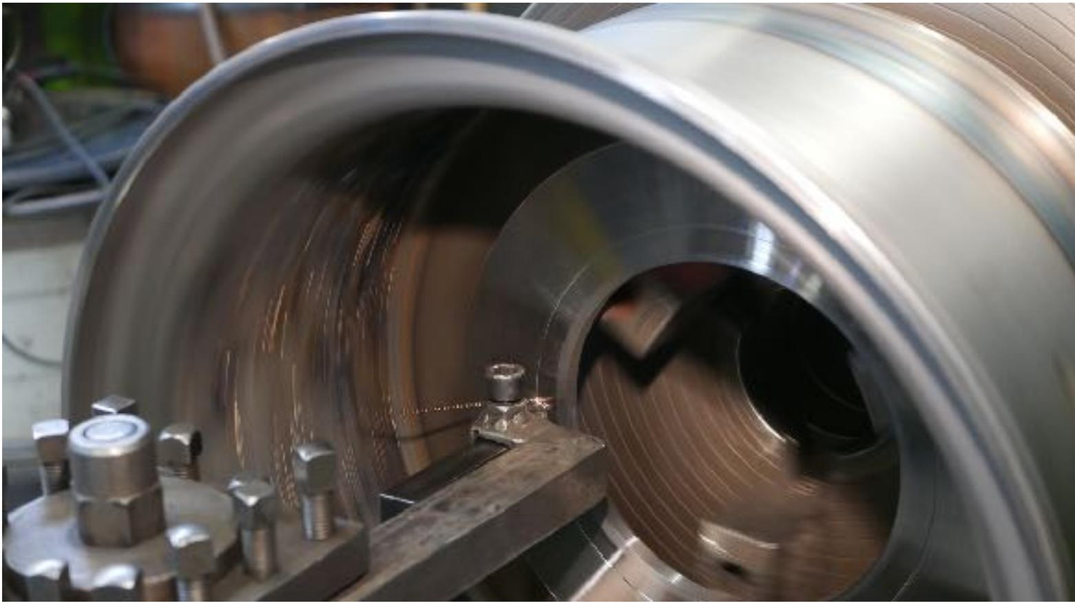
Beim Flachdrehen wird die Felge wieder so gestellt dass ein möglicher Seitenschlag vermieden wird.
