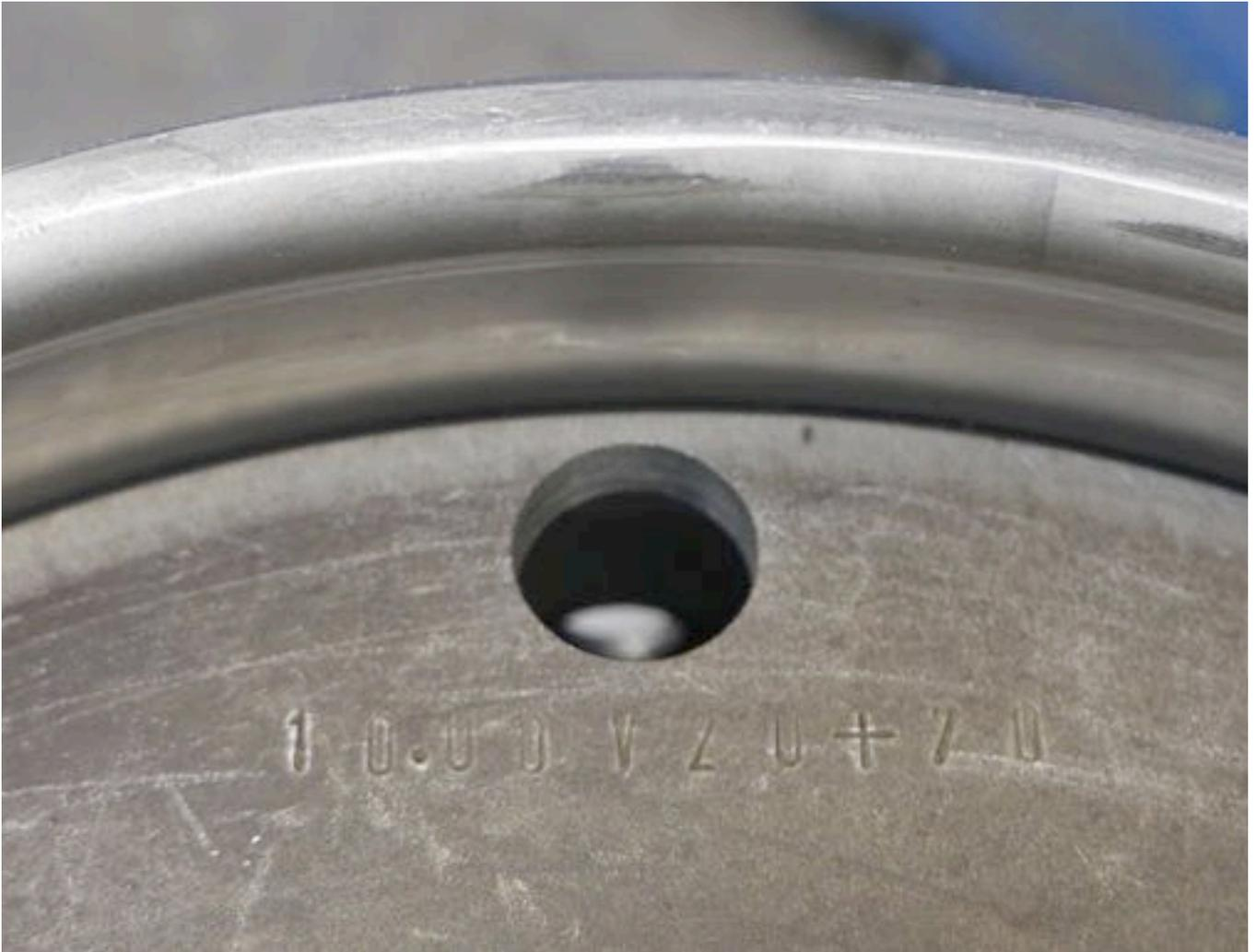
Die Radschüssel wird auf der gewünschte Einpress Tiefe festgeheftet. Vorher wird das Loch gebohrt wo später das Ventil durchgeführt werden kann. Die Schweissnaht kann auf diese Weise an beide Seiten ohne Unterbrechung gelegt werden.
