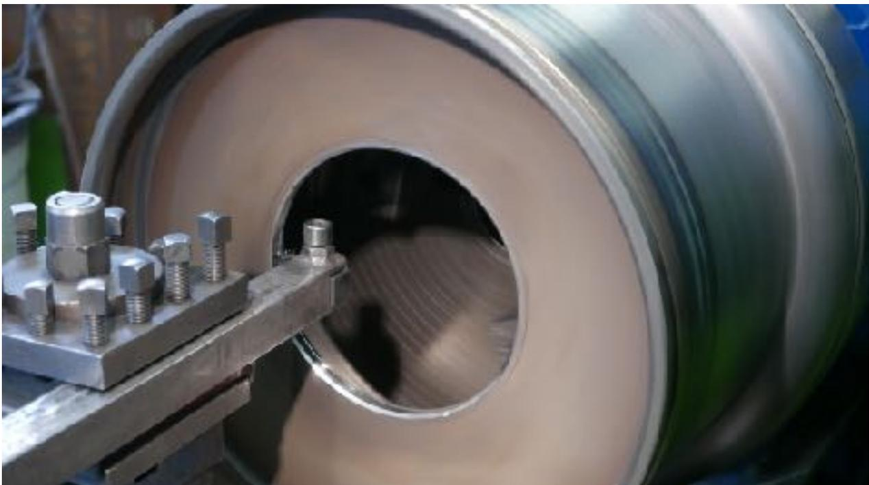
Nachdem die Felge rund- und rechtgestellt ist wird das Mittelloch gedreht. Auf diese Weise ist eine Höhenschlag ausgeschlossen.
