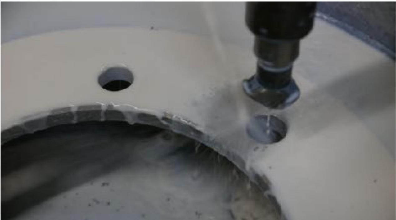
Mit ein Fräser werden die Löcher zweiseitig entgratet und wird die ganze Felge kontrolliert auf Graten und Schweisspritzer.
