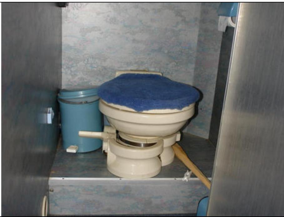
Das WC wird durch den direkt darunter liegenden Schwarzwassertank entsorgt.
